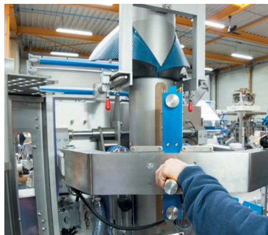
Met de vormschouder wordt de kunststoffolie in een sleuf samengevoegd en geseald.
