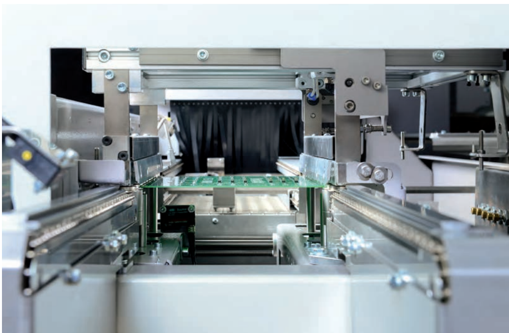
Een shuttle (werkstukdrager) vervoert de printplaat naar de verschillende processtations
