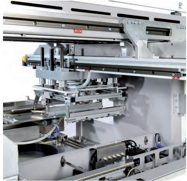
Een xyz-robot verplaatst het bord naar de andere zijde van de machine waar het solderen plaatsvindt
