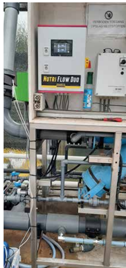
De klant stelt zelf de EC-waarde in en dan volstaat een startcommando om de pomp afzonderlijk te kunnen regelen.
