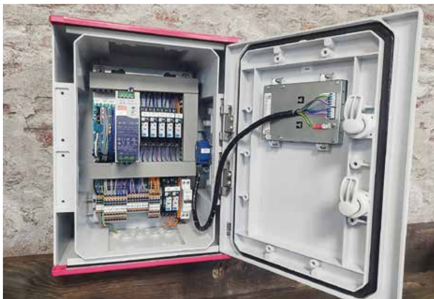
Het systeem maakt gebruik van gemaakt van een CP 102-processorunit en AM442/DM161-modules voor zowel analoge als digitale in- en uitgangen van SIGMATEK.
