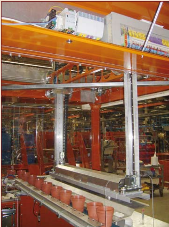
Detail van de Linea Recta met onder de besturingskast de twee servomotoren die volgens het gantry-principe elke willekeurige bewegingscurve kunnen maken.
