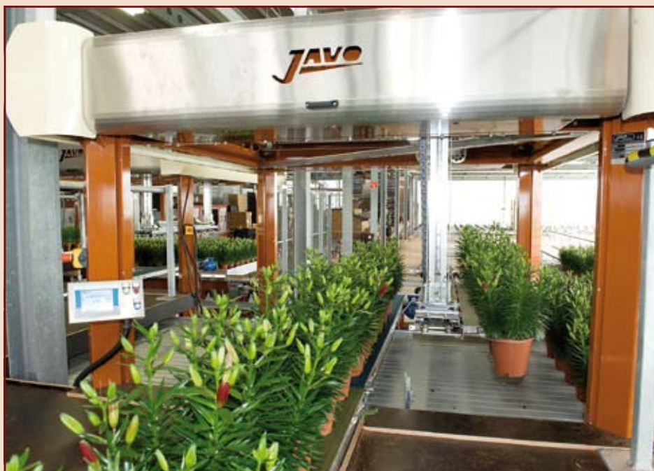
Javo ontwikkelde de Linea Recta, een robot voor het oppakken en neerzetten van potplanten en boomkwekerijproducten met behulp van de objectgeoriënteerde Lasal besturingssoftware.
