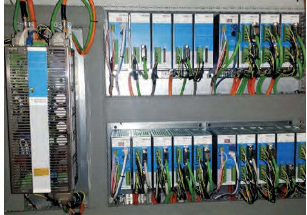
De servosystemen van Sigmatek kunnen servo-, lineaire, hoogkoppel- en asynchrone motoren aansturen en kunnen via de VARAN-bus communiceren met resolvers en met encoders met EnDat-, Hi-Perface- of SinCos-interface. In deze configuratie wordt de boor- en freeslijn aangestuurd.
