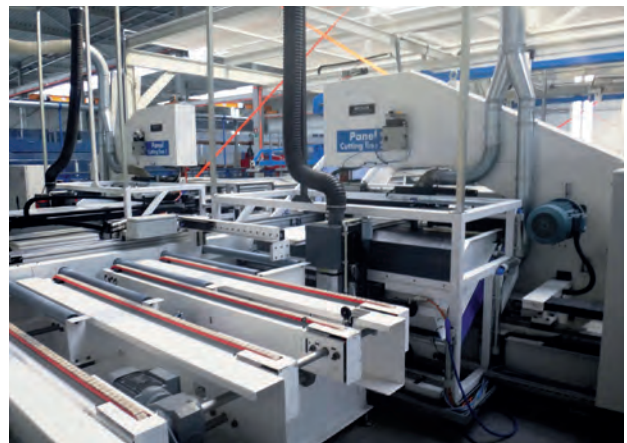
De zaagmachine stuurt de panelen naar de bewerkingsmachines die vervolgens alle verspanende bewerkingen aan het paneel doen, dus frezen en boren.
