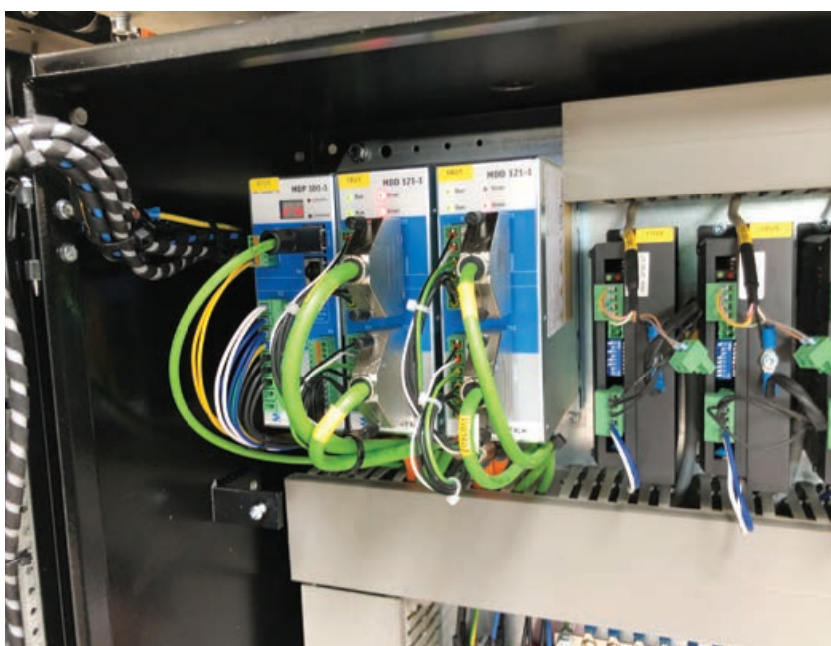
Het modulaire servo drive systeem van Sigmatek voor voeding en feedback maakt gebruik van de Varan bus voor snelle data-uitwisseling
