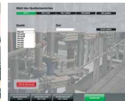
Um die optimale Route zu finden, gibt das Bedienpersonal die Quelle sowie das gewünschte Ziel an. zenon stellt aufgrund einer hinterlegten Matrix den optimalen Weg.
