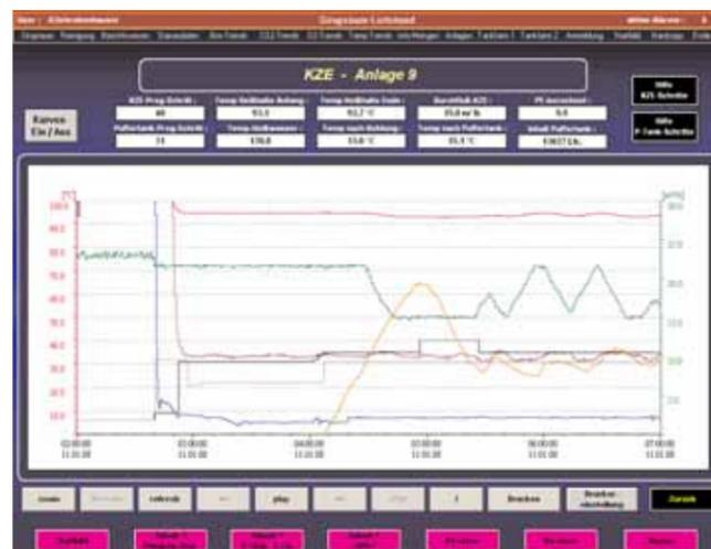
Erweitertes Trendmodul für die Darstellung von KZE (Kurz-Zeit-Erheizungs) Ist-Kennzahlen (Temperatur/Druck/ Durchfluß usw.)
