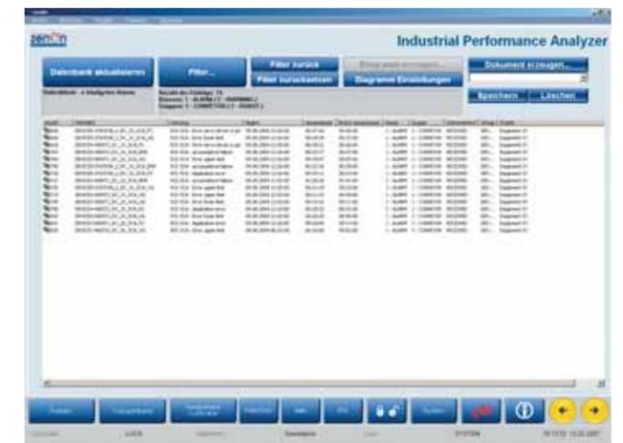
Motorenförderanlage Einsparungspotentiale schnell erkennen und unsere Qualität steigern“, erklärt Zoltan Ponty, Leiter Motorenhandlung bei Audi. In den Anlagen laufen circa 7300 Motoren pro Tag vom Band. Bis zu 22 SPS-Steuerungen liefern eine Vielzahl an Informationen – darunter auch Stör- oder Warnmeldungen. Vor Ort bieten zenon-Visualisierungen den notwendigen Überblick über alle Anlagen. Alle Alarme, die auftreten, werden in einer SQL-Datenbank abgelegt.
