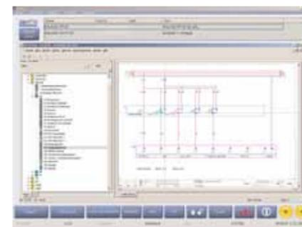
Über den Eplan-Viewer stehen in der Visualisierung zusätzliche Informationen für die Fehlerbehebung oder Wartung zur Verfügung.
