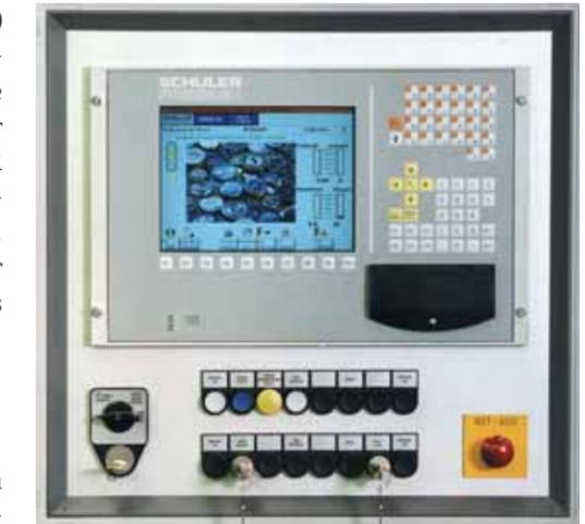
zenon im Einsatz auf einer Münzprägepresse. Das Visualisierungs- und Bedienungssystem ermittelt unter anderem dem Anwender jederzeit den aktuellen Stand der Maschinenleistung wie Preßkraft, Hubzahl, Energieaufnahme und Ausstoß.
