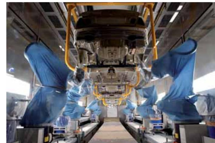
Vollautomatische Unterbodenschutzlinie (UBS).
