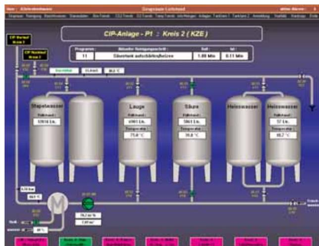
Fließschema eines CIP-Kreises (CIP = Cleaning in Place, zu deutsch: Reinigung vor Ort)
