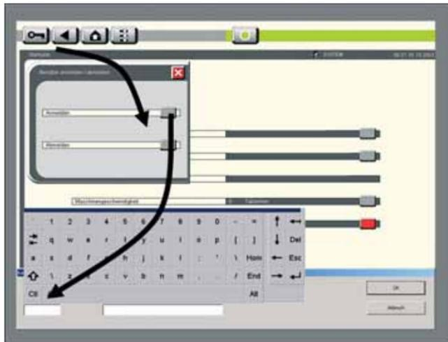
Zugangsregelung über Passwort: Diese Funktion schränkt den Zugriff auf befugte Personen ein. Beim Versuch des unbefugten Anmeldens tritt ein Sperrmechanismus in Kraft.
