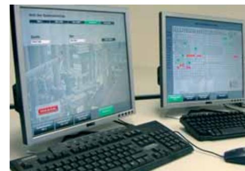
Die zwei zenon-Bedienstationen bei Sasol in Brunsbüttel: In der Messwarte wird mit diesem System parallel zum PLS die Routensteuerung zur Tonerdeförderung realisiert.
