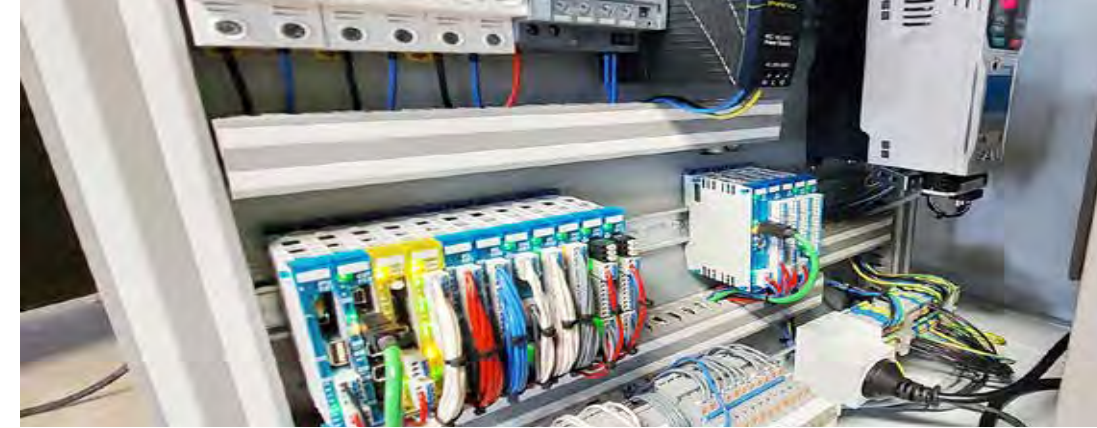
Qua besturing gestandaardiseerd op SIGMATEK; S-Dias standaard- en safety modules.
