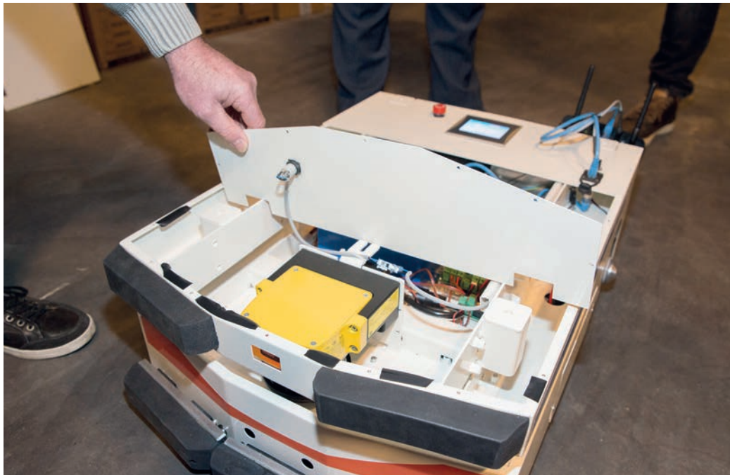
Bij hindernissen op de geprogrammeerde route herkent de veiligheidslaser deze direct en schakelt de besturing over op een uitwijkroute (foto: Kollmorgen Europe).
