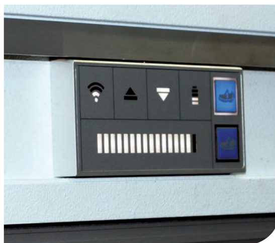
Eén van de talrijke ergonomische details van de nieuwe machine: verplaatsbare display-units geven de operator visuele feedback over de activiteiten van de MagicShoe.
