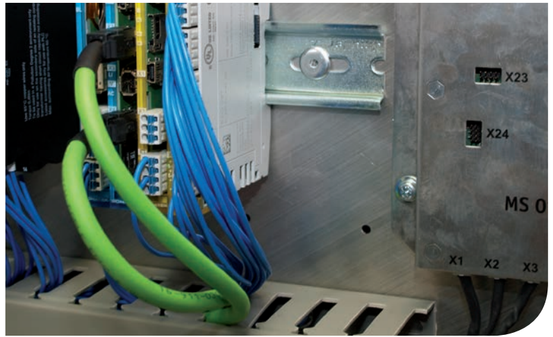
De compacte S-Dias-applicatie bestaat uit een safety en een standaard cpu, gekoppeld aan standaard en safety I/O-modules.
