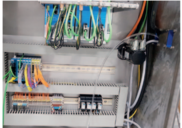
De Modulaire Dias Drives van SIGMATEK sturen de servomotoren aan en kunnen communiceren met bijvoorbeeld SinCos-interfaces. In deze configuratie worden transport- en schietbanden aangestuurd. S-Dias met cpu en safety I/O gekoppeld aan het hard real-time VARAN netwerk zorgen voor de uitwisseling van data.
