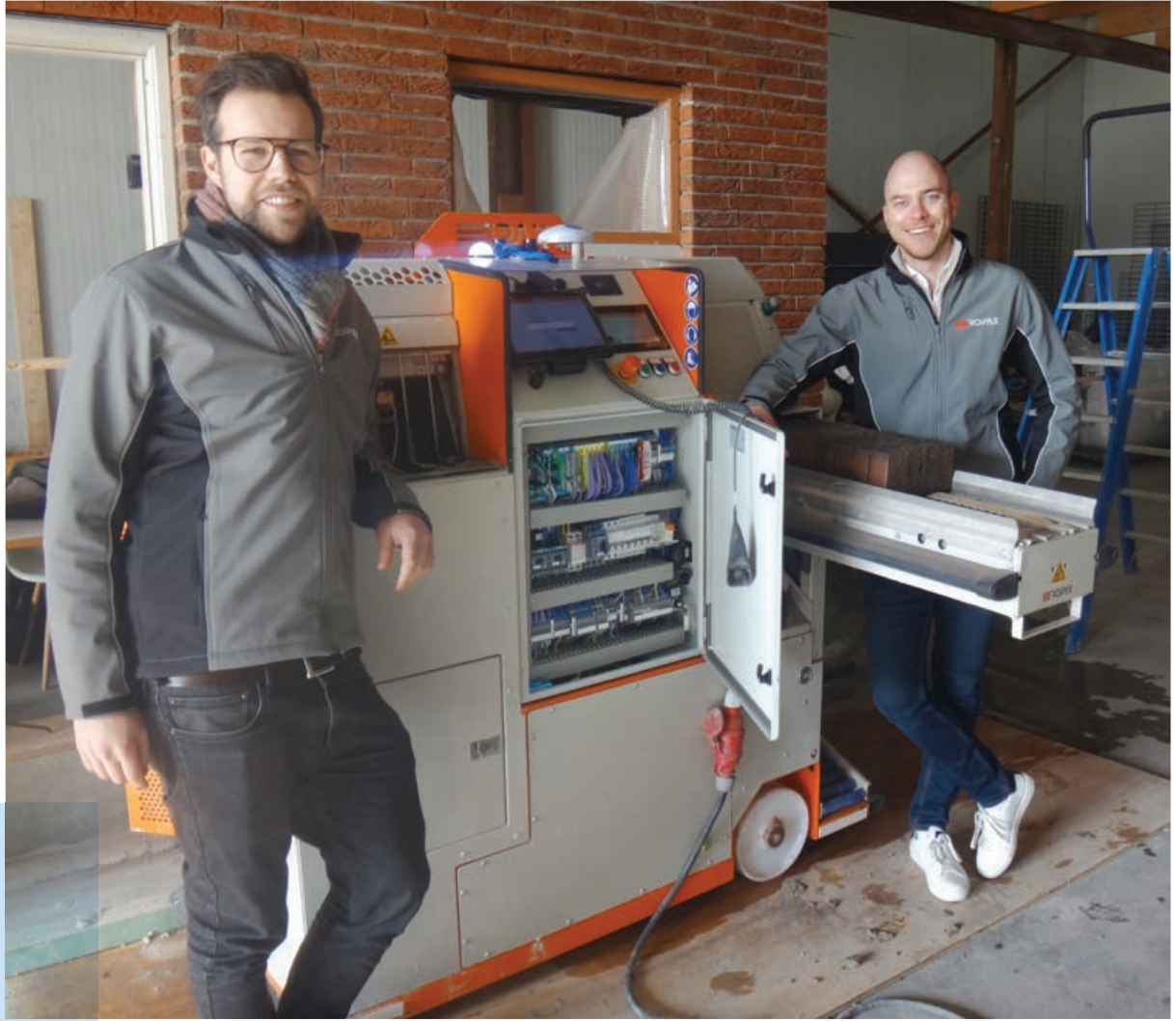
V.l.n.r.: Jelle Overtoom en Colin Gort bij de PAX met servomotoren van Kollmorgen en besturingshard- en software van Sigmatek
