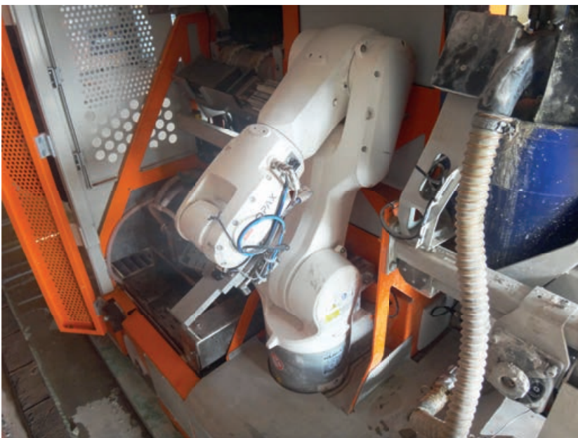
Inkijkje in de machine; linksonder de zaaginstallatie, daarnaast de robot die zowel stenen legt als mortel aanbrengt, rechts de cementpomp-installatie en mortel-aanvoerslang
