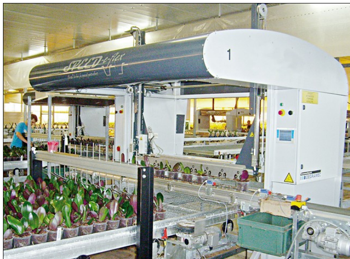
De Speed-e-flex is de eerste overzetmachine in een reeks van dertien, die tijdens het productieproces ingezet wordt
