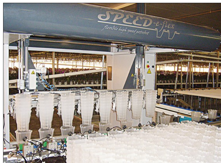
Aan het einde van de productielijn zijn de plantgroei cellen overbodig geworden en worden de lege cups weer getransporteerd voor hergebruik
