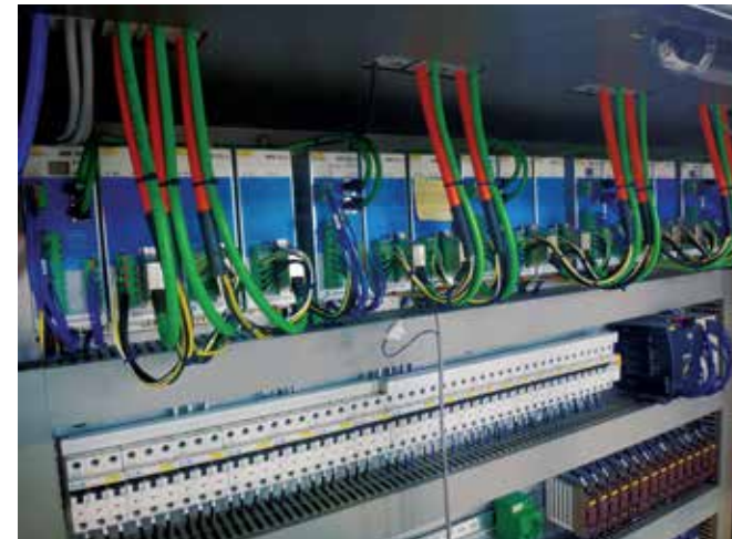
Voor voeding- en communicatie van de servomotoren maakt TG gebruik van het modulaire servo drive systeem van Sigmatek.
