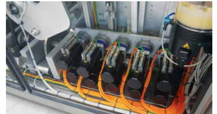
Het gebruik van servomotoren zorgt voor de nodige voordelen. Rechts het volautomatische smeersysteem.
