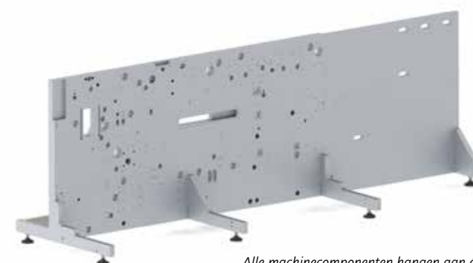
Alle machinecomponenten hangen aan één dik stuk aluminium plaat van zo'n 10 cm.
