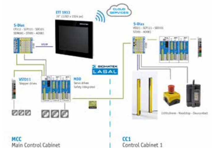
De veiligheidscomponenten zijn direct aan de S-Dias-safety-modules gekoppeld. De communicatie tussen de besturingskasten verloopt via VARAN hard real-time Ethernet.
