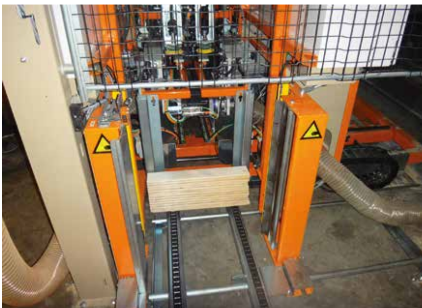
De machine kan in de breedte worden aangepast om planken van 9 x 45 cm tot 22 x 120 cm te kunnen verwerken.
