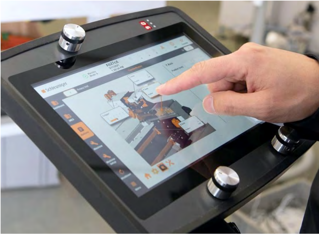
Het draadloze bedienpaneel voorkomt struikelgevaar door lange HMI-kabels en is dankzij OPC-UA-communicatie klaar voor de toekomst
