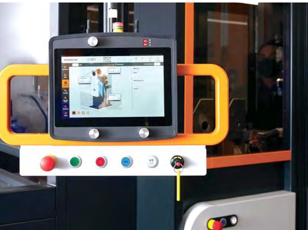
Schleuniger gebruikt in een compleet nieuw ontworpen modulaire machine voor het be- en verwerken van kabels een draadloze HMI van SIGMATEK
