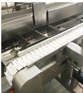
Een pick & place robot plaatst vanaf de transportband repen in een dubbellader
