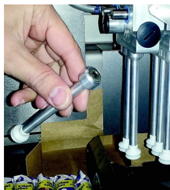
Zuignappen van de grijperkop zijn magnetisch en 'toolless' om te stellen
