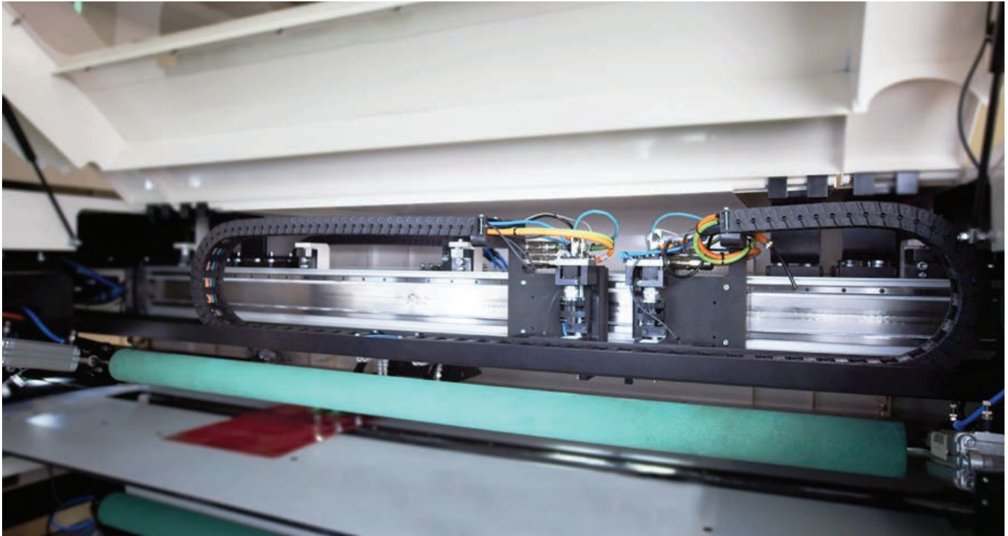
Lineaire motoren worden voor het eerst in de FMM 3.0 toegepast
