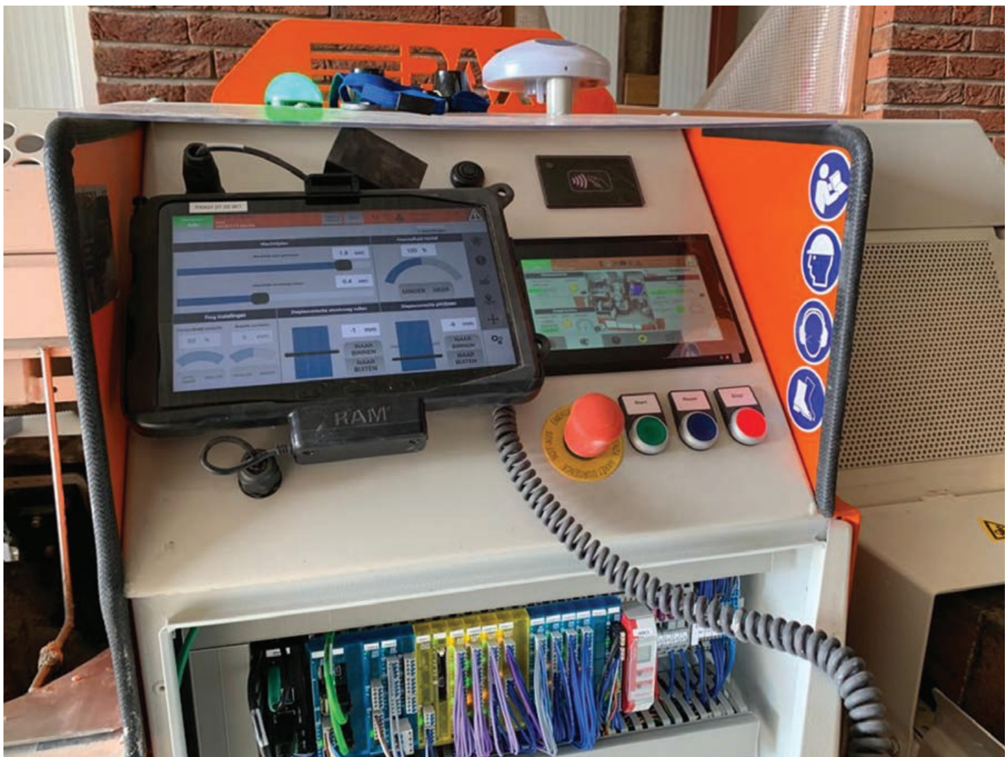
De besturingsconsole met RFID voor toegangsbeveiliging
