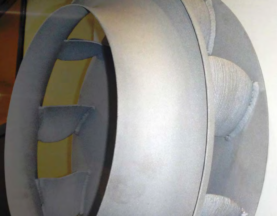
Enkel het printen van fan blades geeft een reductie van 10% in de totale kosten, door deze in 3D-vormgeving verder te optimaliseren.
