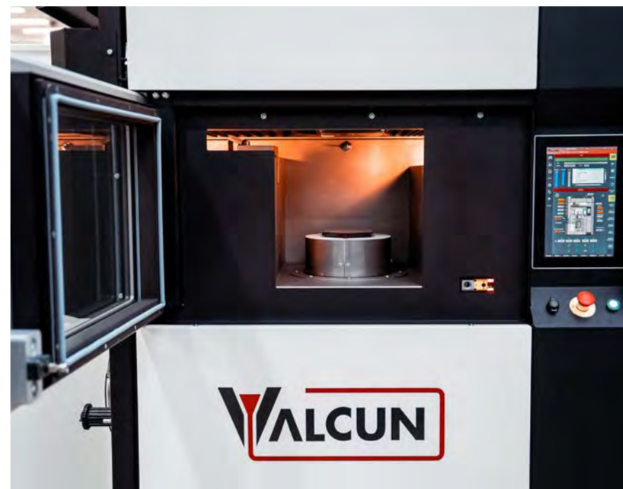
Bedenk dat de printkop een smelttraject moet realiseren tussen de 570 en 660 graden, toch verbruikt de gehele printer niet meer dan 1500 watt vermogen.
