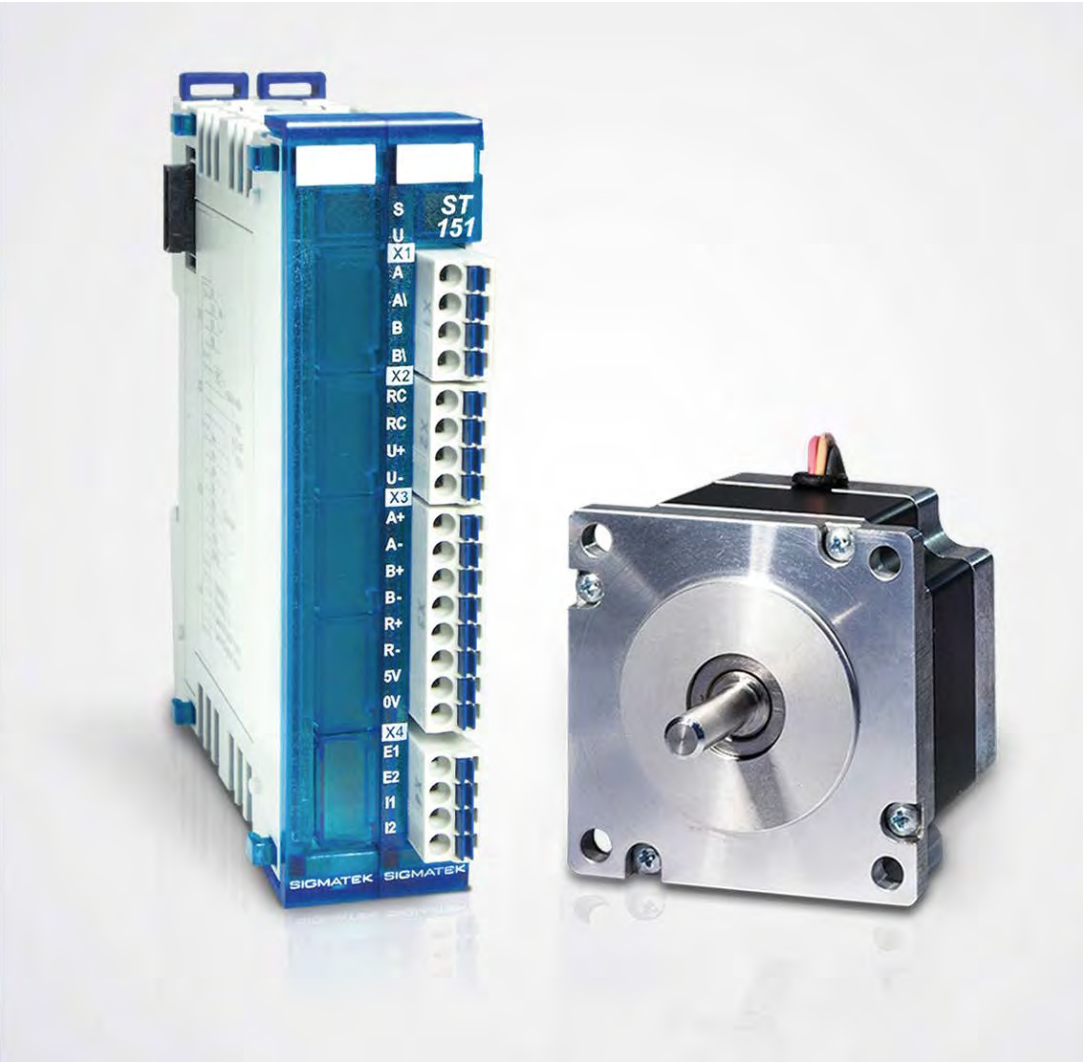
De ST151 van SIGMATEK is een krachtige stappenmotormodule uit de S-DIAS Motion-reeks. Deze compacte module biedt closed-loop besturing met incrementele encoder feedback en tweekanaalsinput voor Safety-functies.
