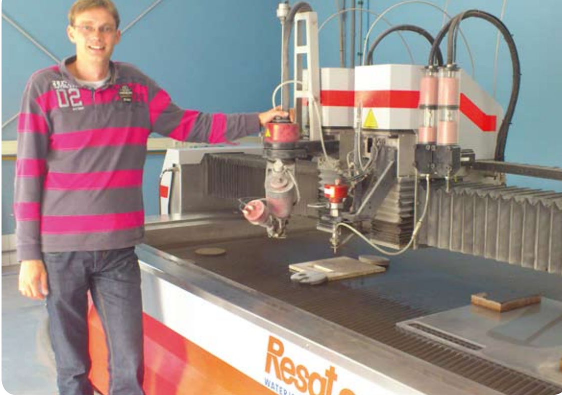
Niek Kristiaan bij de waterstraalsnijmachine die bestaat uit op zichzelf staande blokken, die mede door de modulaire besturing als losse onderdelen kunnen worden verkocht.
